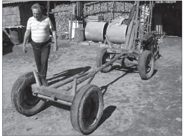
Іл. 14. Триколісна дига (з мотоциклетним двигуном ИЖ-49) з приєднаною «телігою». На фото майстер диги Федір Цюро, 1928 р. н.
