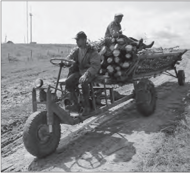
Іл. 13. Дига з мотоциклетним двигуном («інвалідка»), триколісна, з «драбинами»
