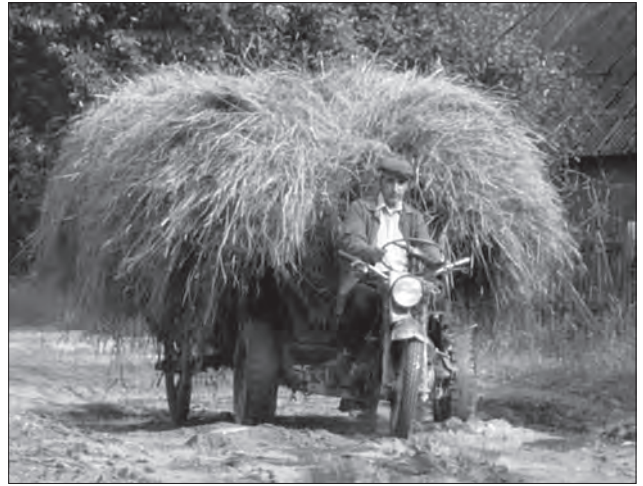
Іл. 10. Дига з мотоциклетним двигуном («інвалідка»), триколісна, з напівпричепом («телією»)
