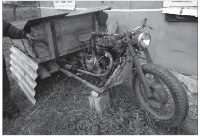
Іл. 7. Дига з мотоциклетним двигуном («інвалідка»), триколісна. Майстер Василь Дністрян, 1934 р. н.
