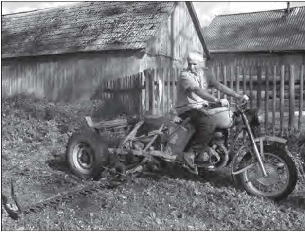
Іл. 9. Дига з мотоциклетним двигуном («інвалідка»), триколісна. Майстер Микола Крупа, 1954 р. н.
