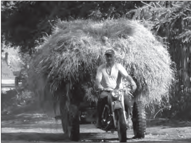
Іл. 11. Дига з мотоциклетним двигуном, триколісна, з напівпричепом («телігою»)
